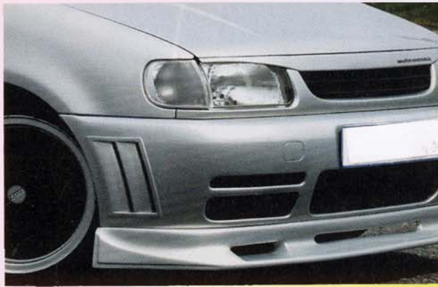
FRONTSCHÜRZEN – EINSATZ PU, Abb. Oben, nur Styling Paket, Garn. Nr: HD 1706 geklebt, TÜV
