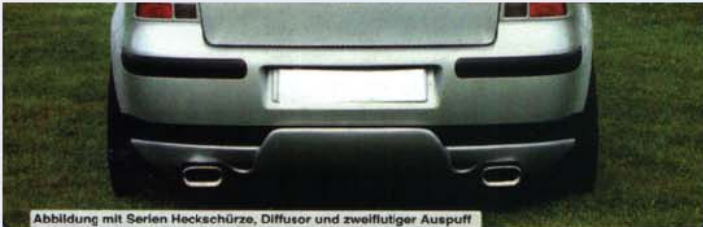
Abbildung mit Serien Heckschürze, Diffusor und zweiflutiger Auspuff
