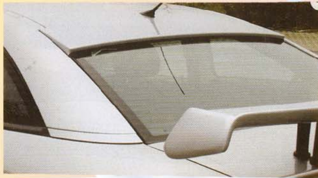
HECKSCHEIBENSPOILER – COUPE ABS, geklebt Abb. oben Best. Nr. HD 1604 einfache Montage
